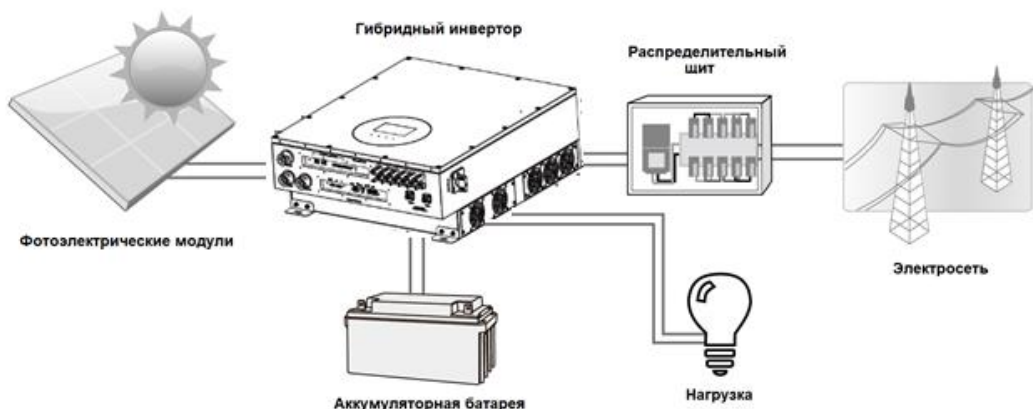
Рисунок 1 Структурная схема подключения гибридной солнечной электростанции
